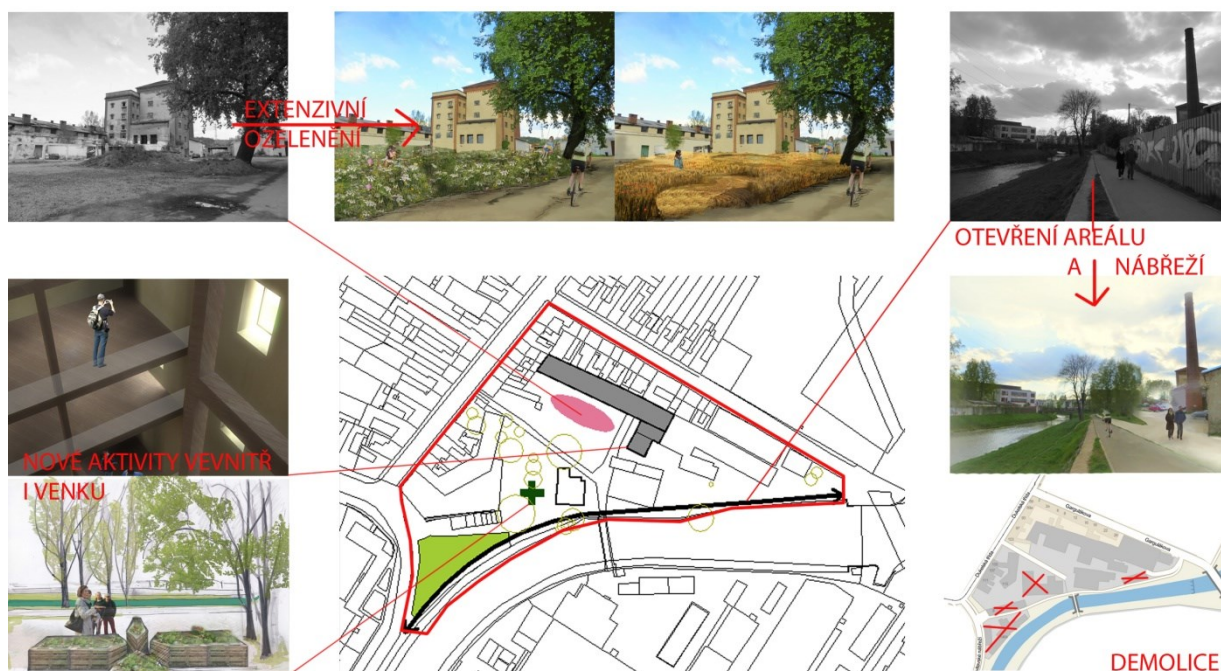
Obr. 13 Schéma I. Etapy – zpřístupnění areálu a nábřeží (demolice budov a plotu, promenáda na nábřeží), zatraktivnění – estetické (např. extenzivní ozelenění) a nabídka nových aktivit vevnitř (rekonstrukce budovy sladovny) i venku (např. lékárenská zahrada, či piknikový trávník).
